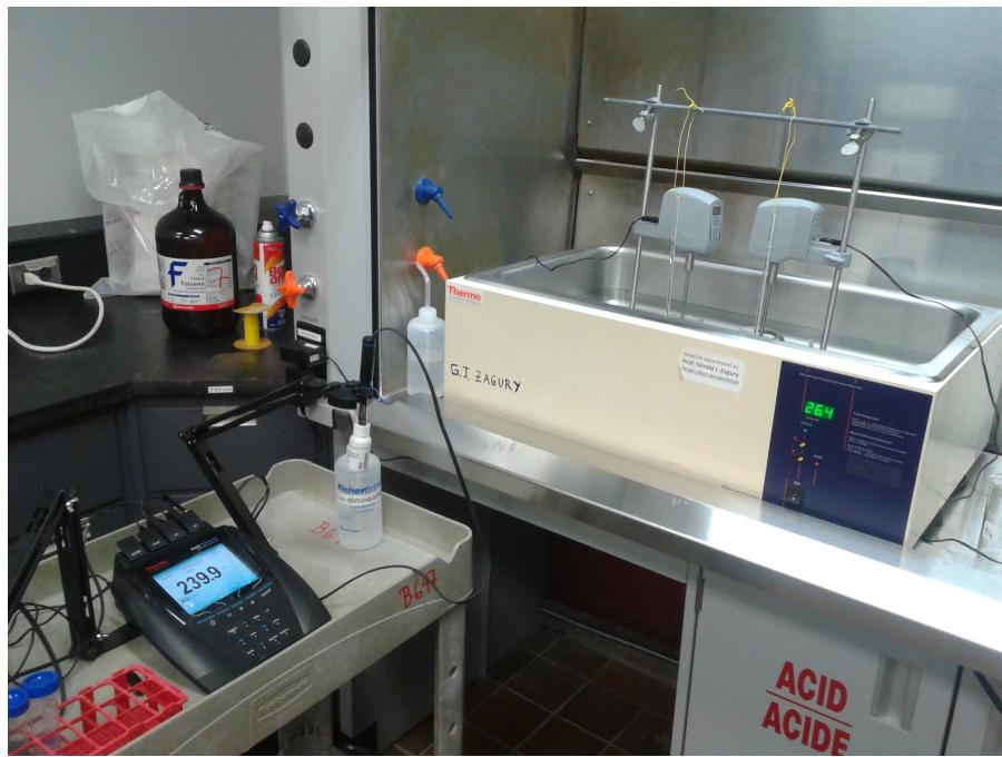
Figure 3.6 Espace de travail pour la prise des mesures du pH, de la température ainsi que de l'ORP.
