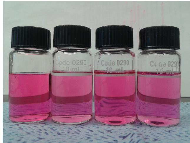
Figure 3.3 Coloration de l'échantillon pour la mesure de concentration en peroxyde d'hydrogène.
