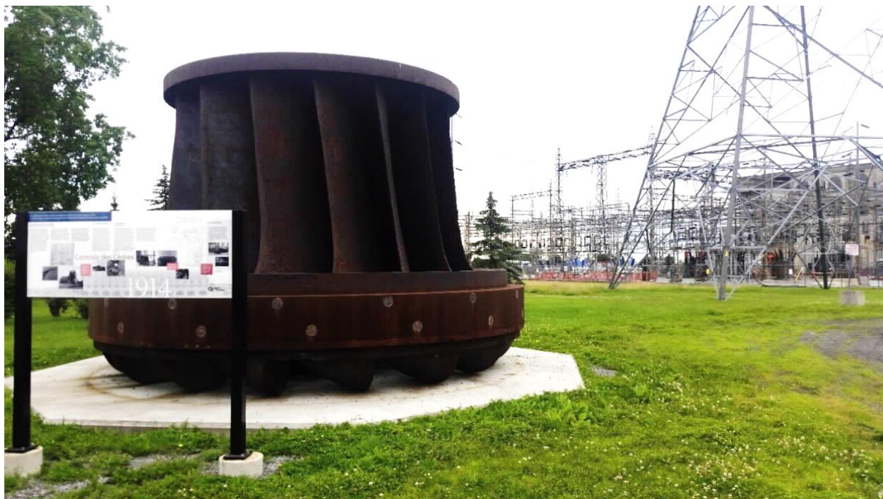
Figure 1.1: Roue de turbine Francis photographiée à la centrale des cèdres
