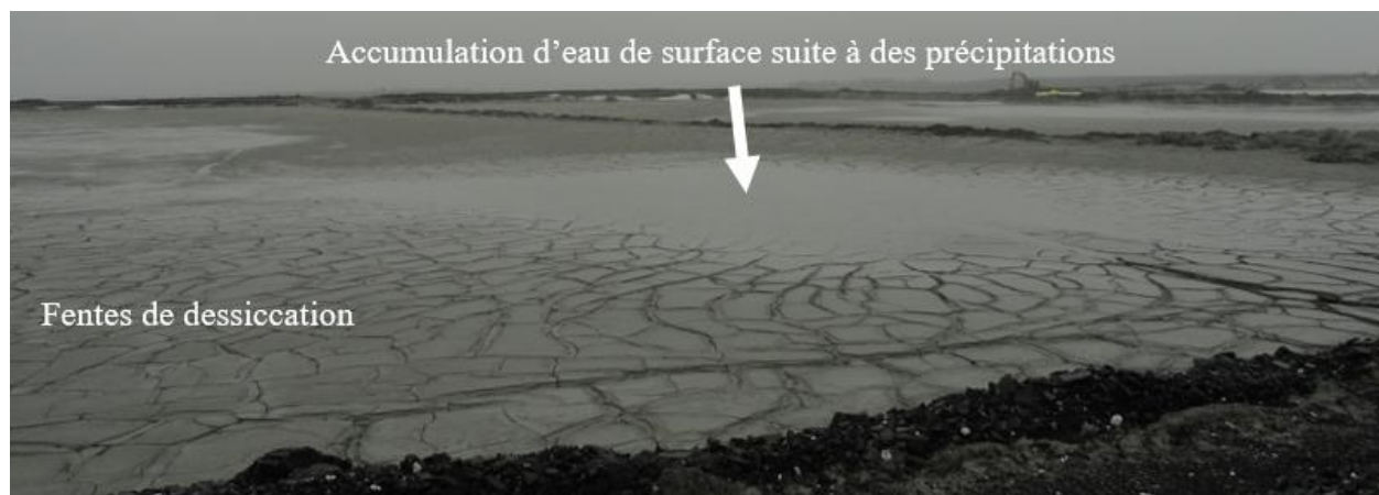
Figure 4.29: Accumulation d'eau et fentes de dessiccation à la surface des résidus à proximité de l'inclusion de stériles # 9, 50 jours après la fin de la déposition (parc à résidus de la mine CM, septembre 2017).
