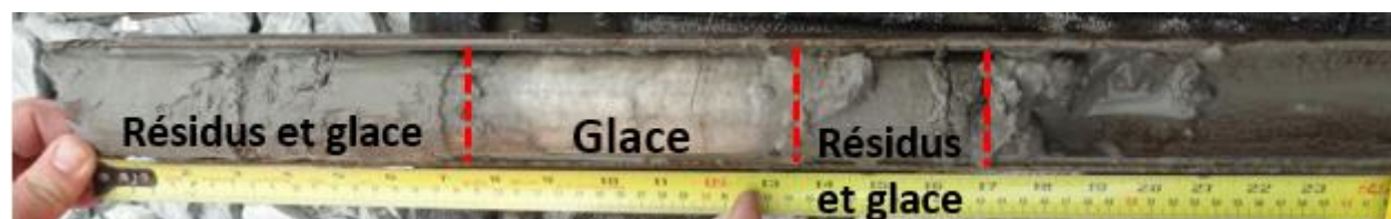
Figure 4.30: Lentilles de glace (épaisseur de 15 cm) dans le forage PZ-IRME-10 entre 16,46 et 17,07 m sous la surface des résidus miniers.
