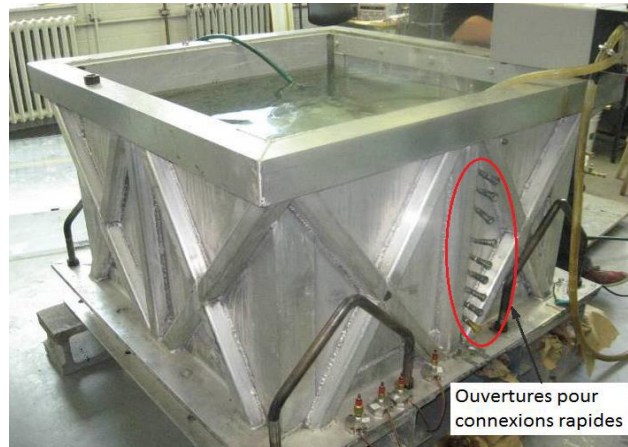
Figure 2.17: Cellule à parois rigides avec une base carrée (105cm × 105 cm) et une hauteur de 75 cm utilisée pour des essais sur modèle physique avec des résidus et une IRS (Tirée Saleh-Mbemba (2016)).
