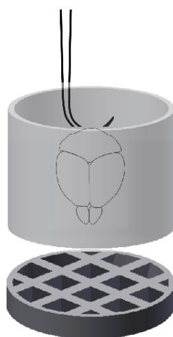
Figure 3.11 : Module de fixation de l'échantillon dans l'agarose. Un crochet maintient l'échantillon à la verticale pendant le refroidissement de l'agarose. Le crochet est planté dans une partie non imagée de l'échantillon, ici le tronc cérébral. Suite à l'ancrage, le crochet et la partie cylindrique sont retirés.
