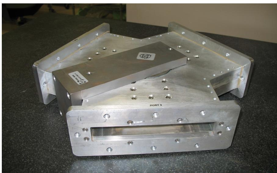
**Figure 5-11: Jonction de circulateur en forme Y symétrique**
