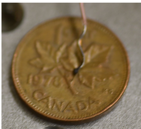
Figure 3.9 Thermocouple de type T fabriqué pour mesurer la température de l'écoulement. La pièce de un cent est utilisée pour illustrer la taille
