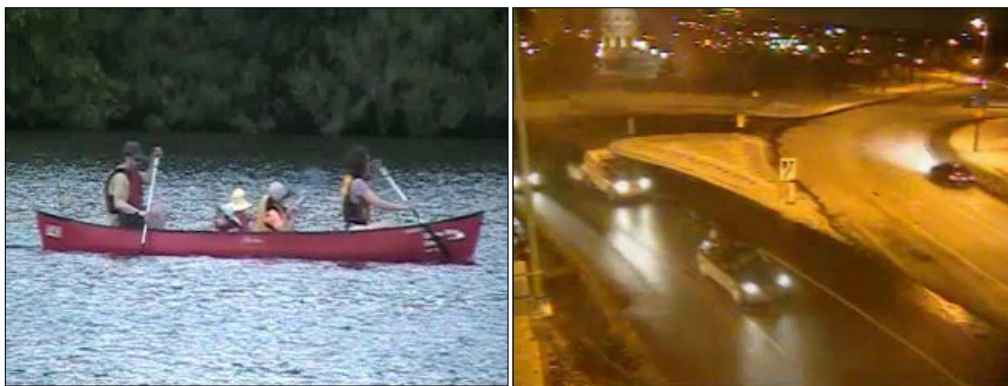
Figure 1.3 Exemples de problèmes pouvant affecter une méthode de détection et de segmentation d’objets d’intérêt tirés du jeu de données de Goyette et al. (2012). À gauche, l’eau présente une surface d’arrière-plan d’apparence dynamique difficile à modéliser. À droite, les changements d’illumination causés par les reflets de phares sont difficiles à ignorer.
