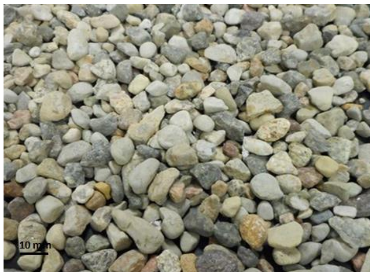
Figure 3.2: Gravier 5-10 mm utilisé dans la colonne de neutralisation no. 1
