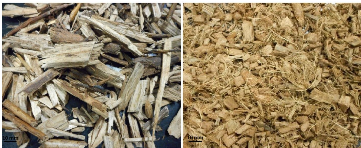
Figure 3.5 : Copeaux de saule utilisés dans la colonne no. 1 et noix de coco utilisé dans la colonne no. 2
