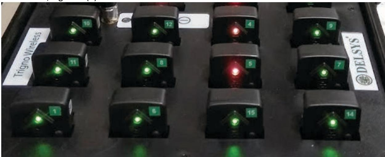
**Figure 2. Capteurs dans la boîte de recharge.** LED vert = capteur entièrement chargé; LED jaune = capteur en train de charger.
