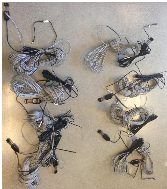
Figure 3-12: Installation d'extension de câbles stéréo pour augmenter la longueur des câbles des cellules 5TE.
