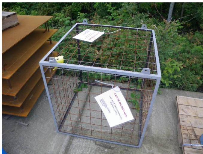
Figure 3-10: Cage en acier utilisée pour attacher les instruments de mesure.
