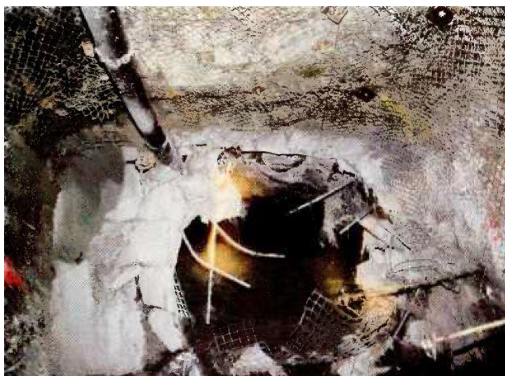
Figure 1-4: Rupture d'une barricade de béton projeté (P. B. Hughes, 2008).
