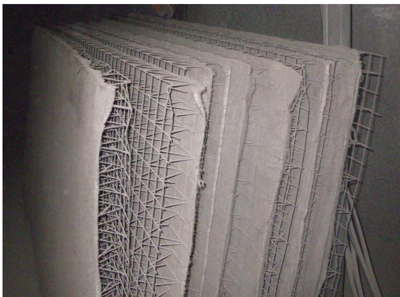
Figure 2-7: Matelas utilisés pour la construction de mur de ventilations ou jadis pour boucher le haut des barricades de stériles à la mine Louvicourt (photo prise dans une baie de matériau au niveau 114, à la mine LaRonde).
