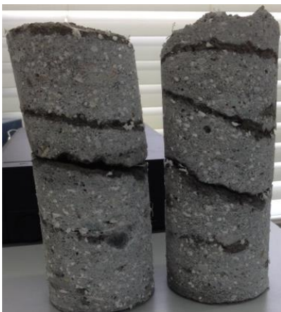
Figure 4-8: Carottes de béton projeté avec strates de faiblesse causées par l'ajout excessif d'accélérateur (Sylvestre, 2014).
