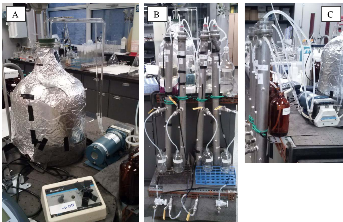
Figure 3-11 : Photographies du réservoir de transfert (A), des colonnes (B) et de la pompe (C) de l'expérimentation en colonne
