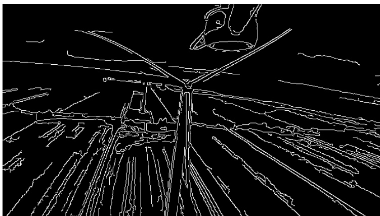
Figure 4.4 Résultat de l'application du filtre de Canny avec T_b = 27 et T_h = 81 .
