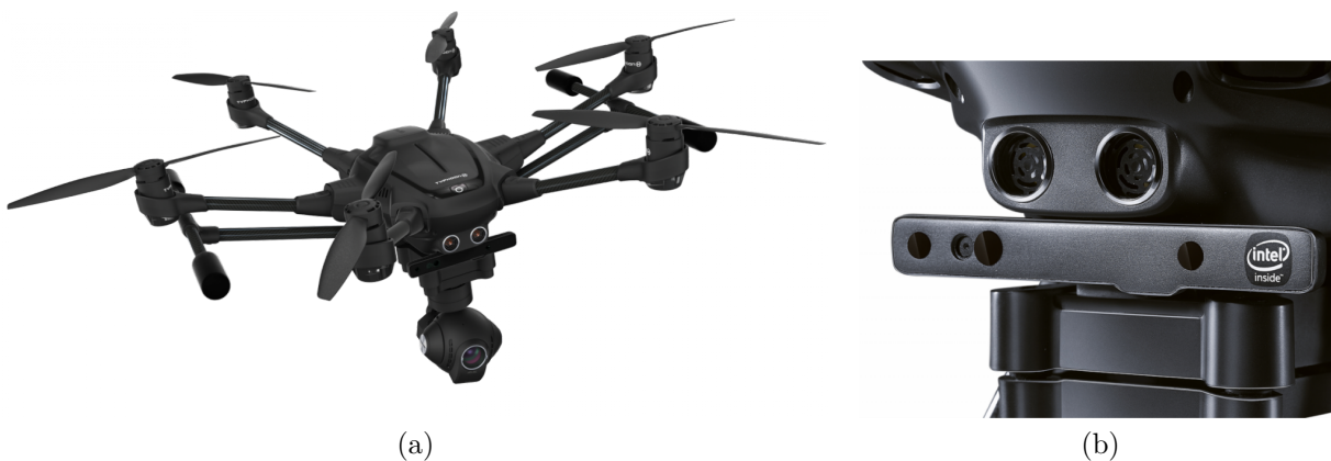
Figure 2.3 (a) Le multi-rotor Yuneec Typhoon H (b) La caméra stéréo infrarouge Intel RealSense augmentée d'un sonar pour détecter les obstacles lors des échecs de perception.
