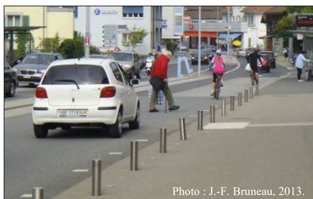
Figure 7.5 : Trottoir élargi à niveau avec bollards (Köniz, Suisse)
