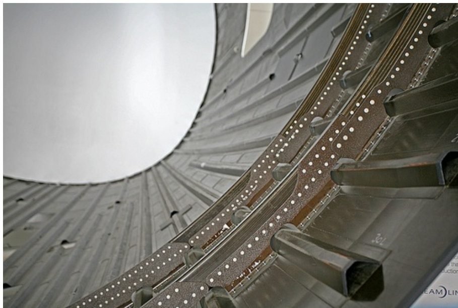
Figure 1.1 Vue interne d'un démonstrateur de fuselage en composite du Boeing 787. © C. Boffoli, 2007 [1]. Reproduit avec permission
