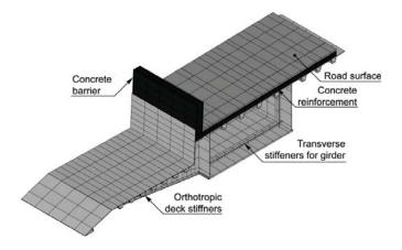
FIGURE 5 - LANGENSAND BRIDGE CROSS-SECTION OF FINITE ELEMENT MODEL
