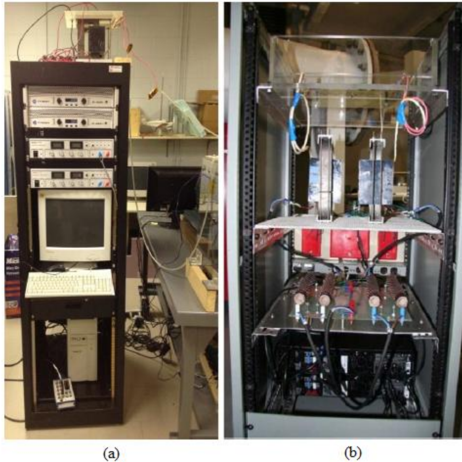
Figure A.2 : Photo du système d'alimentation; (a) Vue générale, (b) connexions des amplificateurs, des résistances et des transformateurs
