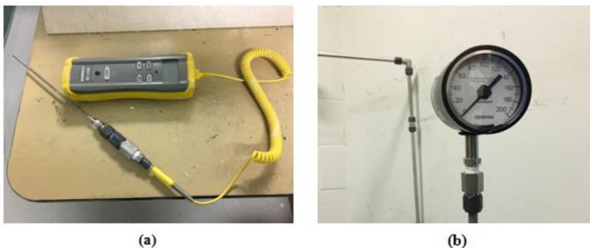
Figure 3.6 : Outils de mesure de la température et de la pression utilisés sur le banc d'essai:
