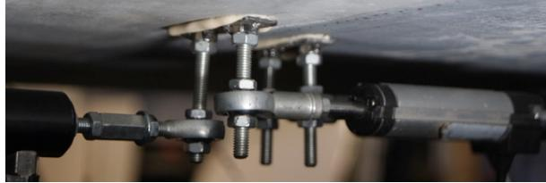
a) Tiges capteurs fissures (simple et double)
