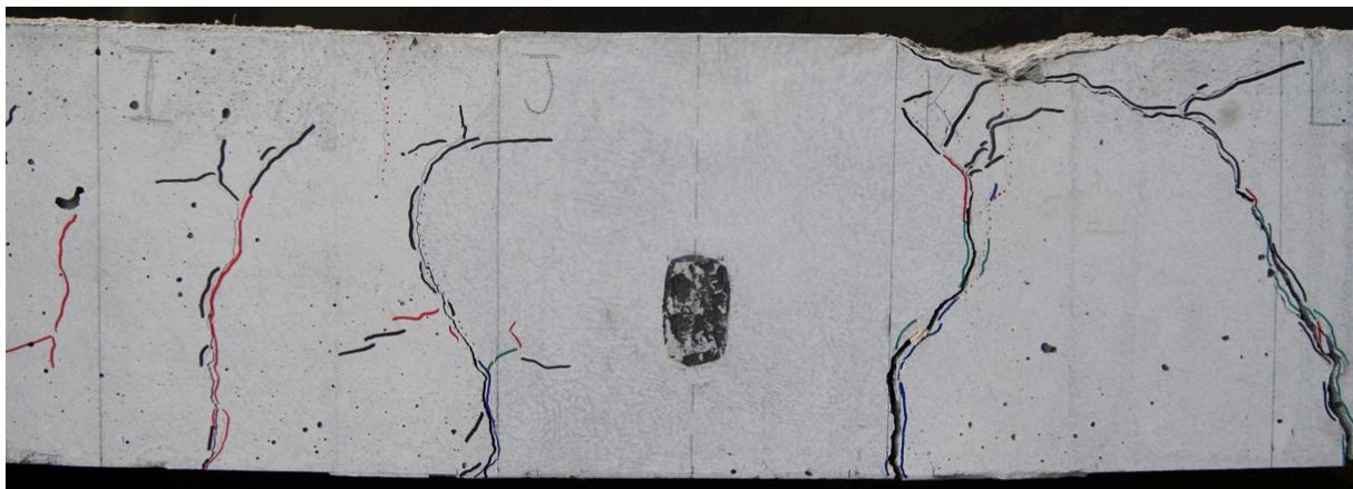
Figure J- 14 : Face sud – Dalle 17 (3o-D-Q-1-S) – Après rupture
