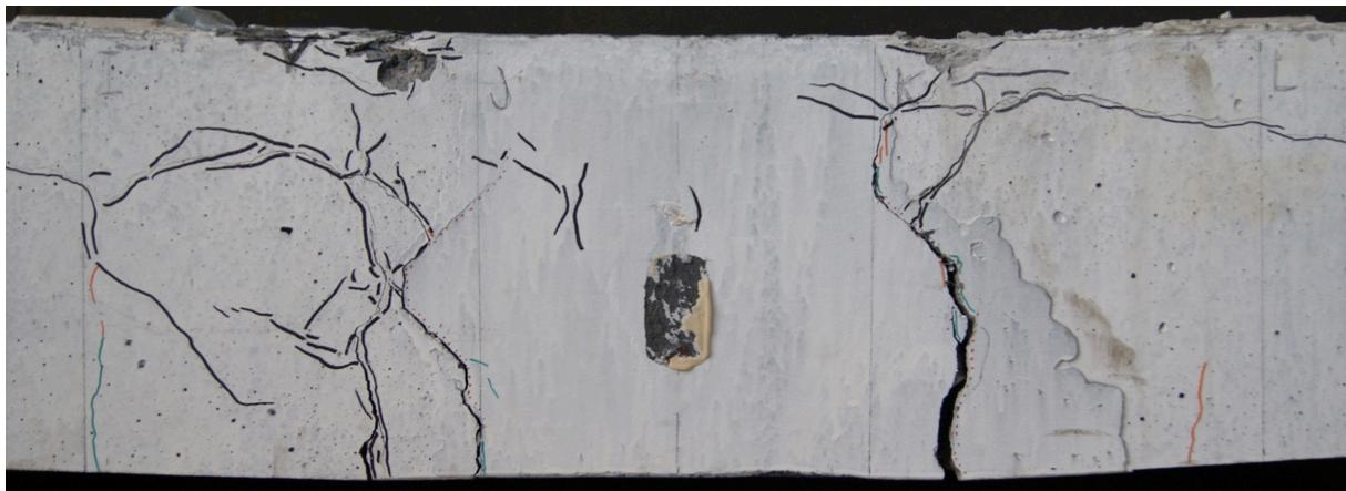
Figure J- 10 : Face sud – Dalle 13 (2o-U-Q-1-S) – Après rupture
