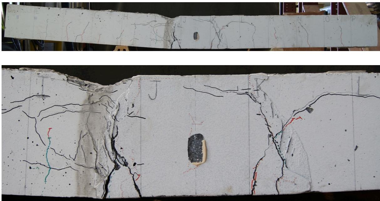
Figure J- 12 : Face sud – Dalle 15 (2\*o-U-Q-1-F) – Après rupture
