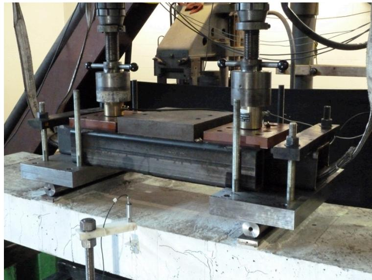
**Figure 3-19 : Montage pour la seconde mise en charge de la dalle 02 (0o-D-C-3-F)**
