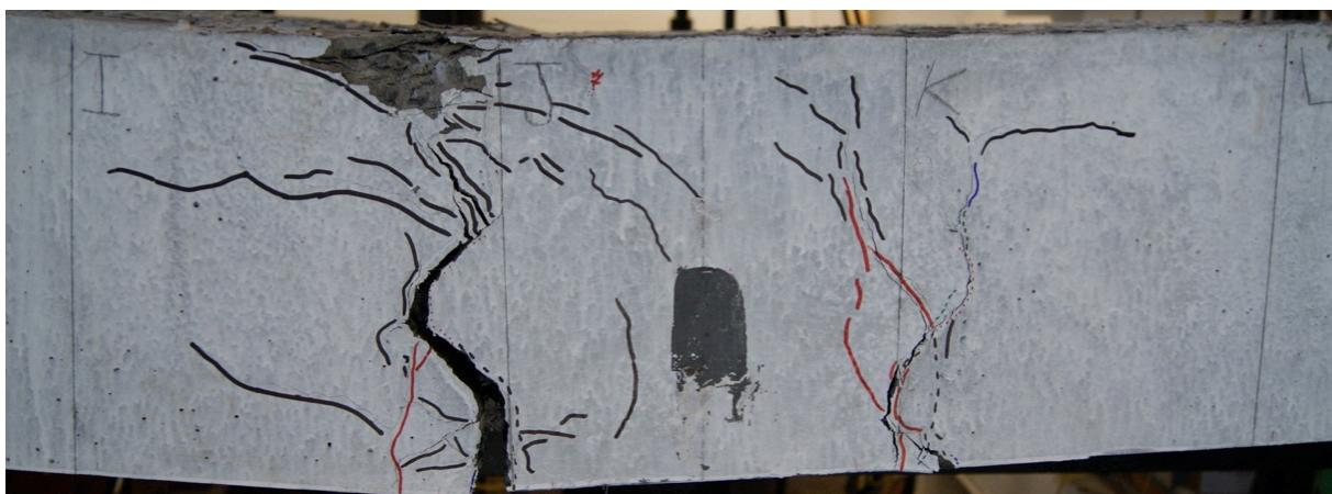
Figure J- 19 : Face sud – Dalle 22' (2f-U-Q-1-F) – Après rupture
