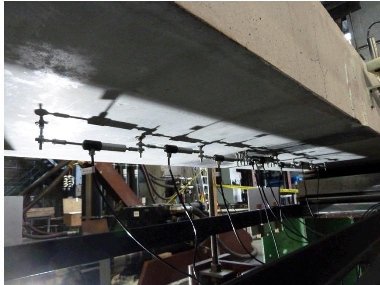
**Figure 3-22 : Capteurs d'ouverture de fissures**
