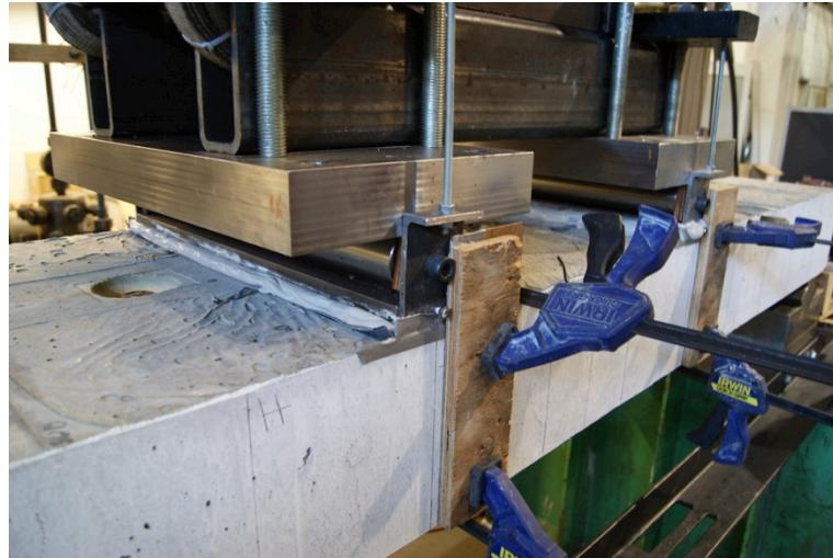
**Figure 3-16 : Gabarits de positionnement du système de chargement sur la dalle**
