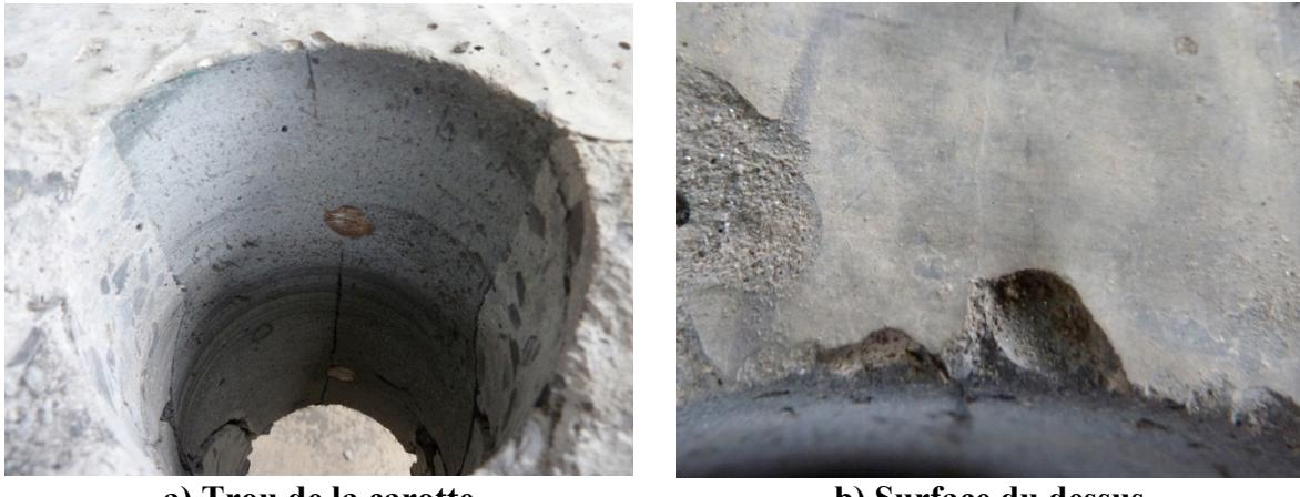
**Figure 4-59 : Fissuration de retrait dans le BFUP – Dalle 16 (2o-U-Q-1-F)**
