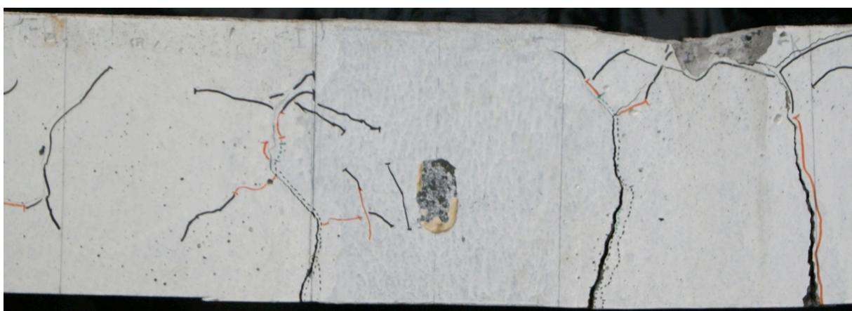
Figure J- 5 : Face sud – Dalle 06 (2o-D-Q-0-F) – Après rupture
