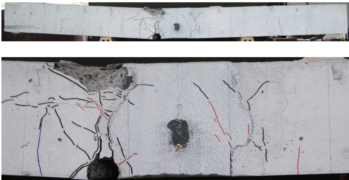
Figure J- 17 : Face sud – Dalle 20' (3o-U-Q-1-F) – Après rupture
