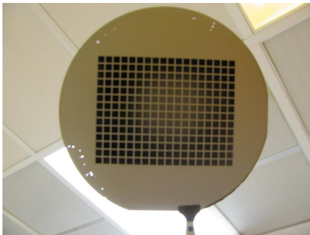
Figure 6.28 : Face arrière d'une tranche après formation des TSV arrière lors du premier test d'assemblage.
