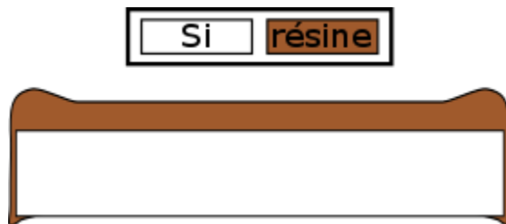
Figure 3.4 : Résine présentant des perles au bord de la tranche.
