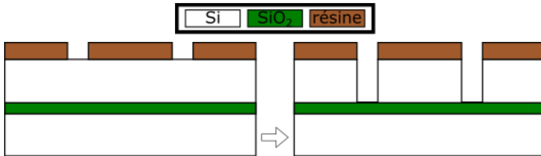
Figure 3.8 : Exemple d'arrêt de gravure par une couche enterrée de haute sélectivité.
