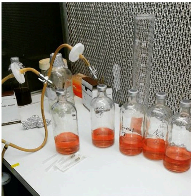
Figure 4 : Montage permettant l'instauration de l'anaérobiose grâce à un flux d'azote dans les flasques contenant le milieu de culture
