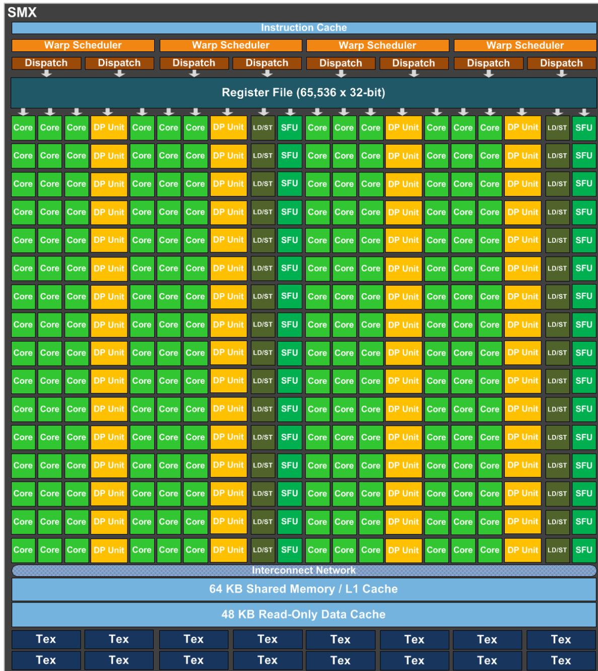
Figure 2.18 Un Streaming Multiprocessors de la GeForce 780 Ti contient 192 unités en simple précision (Core), 64 unités en double précision (DP Unit), 32 unités load/store (LD/ST) et 32 unités de fonctions spéciales (SFU), tirée de NVIDIA (2012)
