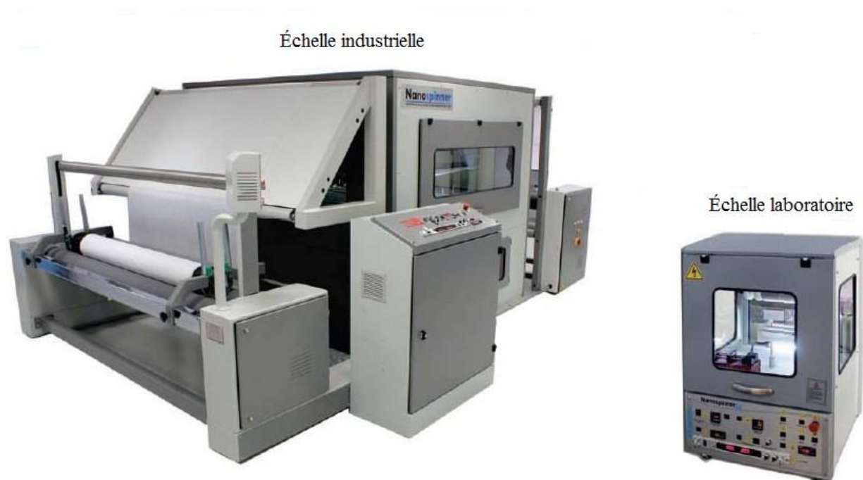
Figure 2.9: Montage d'électrofilage de laboratoire versus un dispositif industriel (Nanospinner®)
