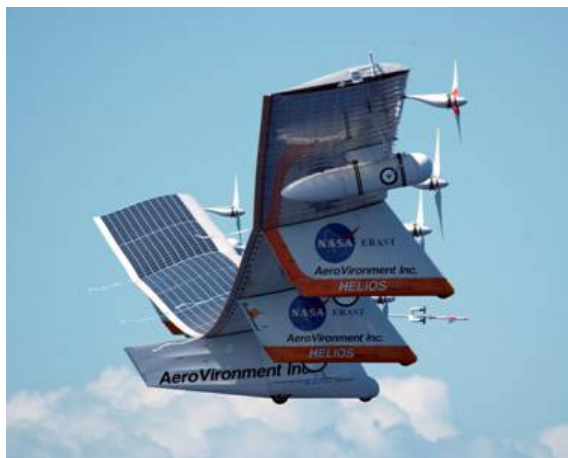
(b) Déformation stationnaire d'un drone à longue endurance NASA Helios [64]
