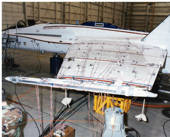
(a) Identification au sol de la réponse structurelle d'un avion [1]
