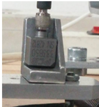
Figure 3.50 Accéléromètre PCB 333B50
