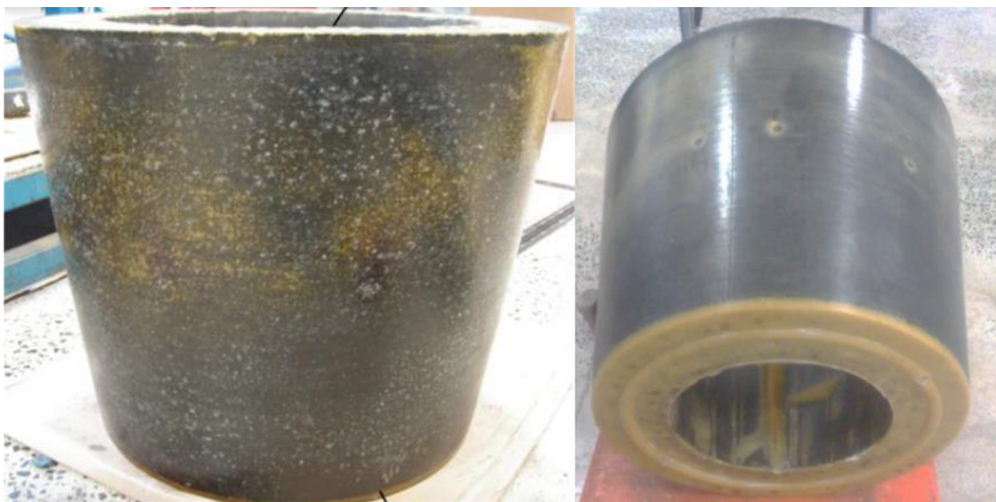
Figure 7-7 : Pièce conique de forte épaisseur carbone/phénolique fabriquée avec le procédé d'injection flexible [24]
