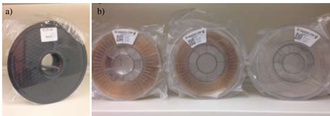
Figure 5-1: Bobines de filaments de a) PC et b) PPSU, PEI et PEEK
