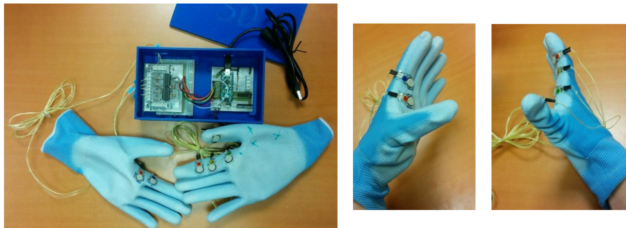
Figure 4.6: Dispositif complet d'enregistrement des forces, et zoom sur les gants gauche et droit. (© S.D. Étudiante, 2017)
