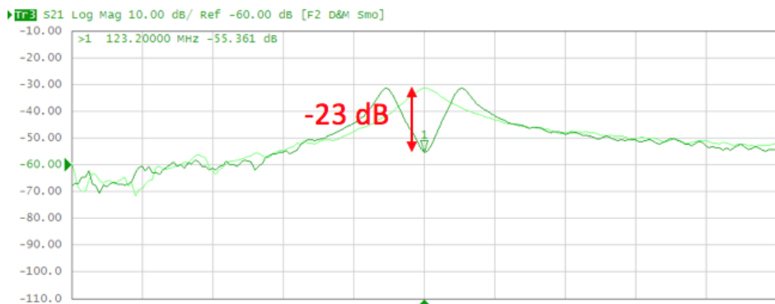
Figure 4.6 – Mesure du découplage par préamplificateur de la boucle 3 (en vert clair : mesure du coefficient de réflexion avec la résistance, en vert foncé : mesure du coefficient de réflexion avec le préamplificateur).
