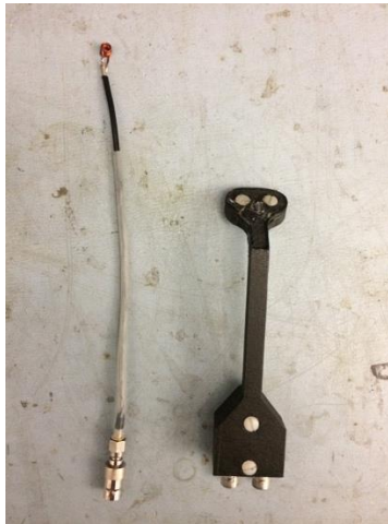
Figure 3.11 - Sondes utilisées durant les tests sur le banc d'essai. Gauche : sonde « renifleuse. Droite : Double sonde.
