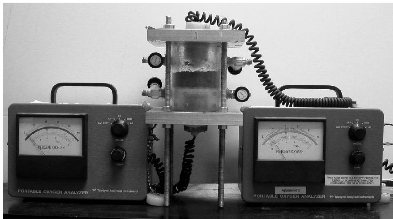
Figure 2-5: Dispositif d'essai diffusion et consommation de l'oxygène à chambre double (tiré de Gosselin, 2007)
