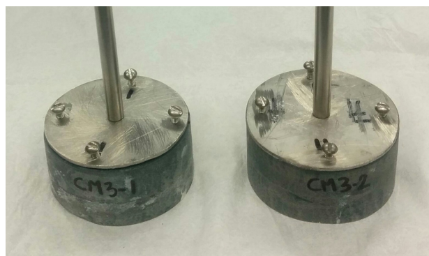
(b) Supports de PVC fixés à la tige rotative par des plaques en acier inoxydable
