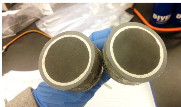
(a) Échantillons de calcaire fixés dans leur support par de la colle époxy
