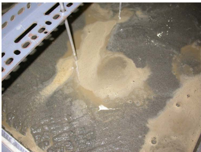
Figure 3.31. Formation de bouillons de sable au sommet de l'échantillon (essai 3).
