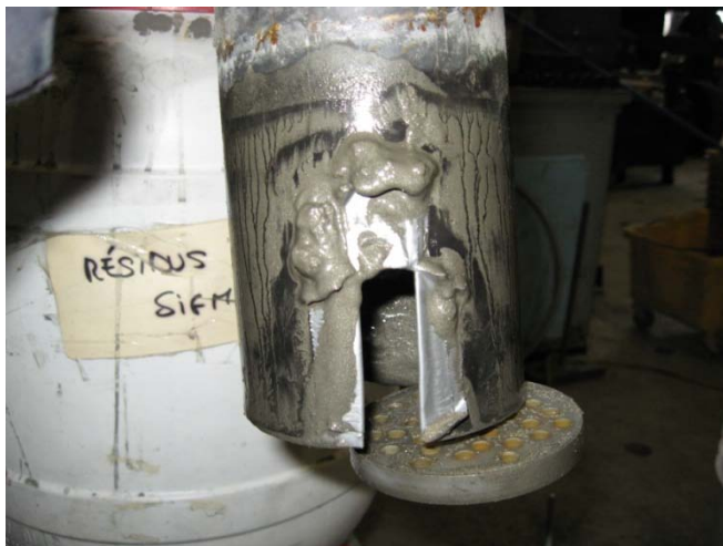
Figure 3.21. Fente découpée dans le cylindre métallique afin de ne pas déranger la position des filtres métalliques et des tubulures dans le sable grossier (essai 8).
