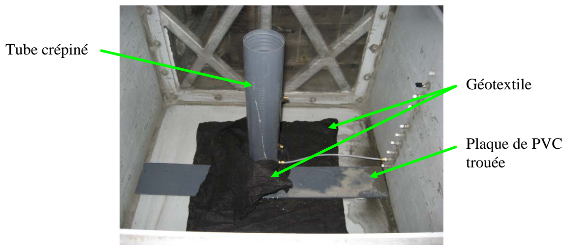
Figure 3.14. Stabilisation du tube crépiné à la base de l'échantillon (essai 6).
