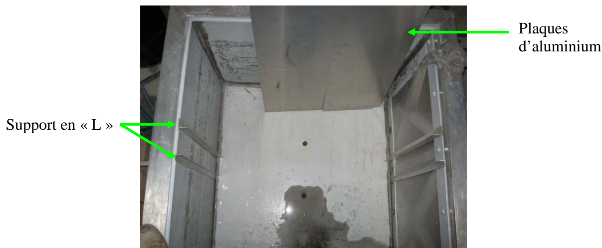
Figure 3.23. Supports en « L » collés aux parois (essai 9).
