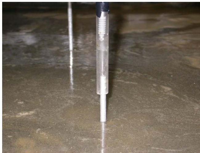
Figure 3.11. Tube de plastique entourant la pointe du LVDT pour l'essai 3.
