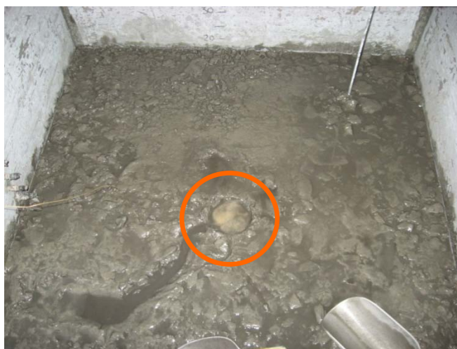
Figure 3.20. Colonne de sable centrée dans le montage après avoir retiré le cylindre métallique entre la mise en place de deux couches (essai 8).
