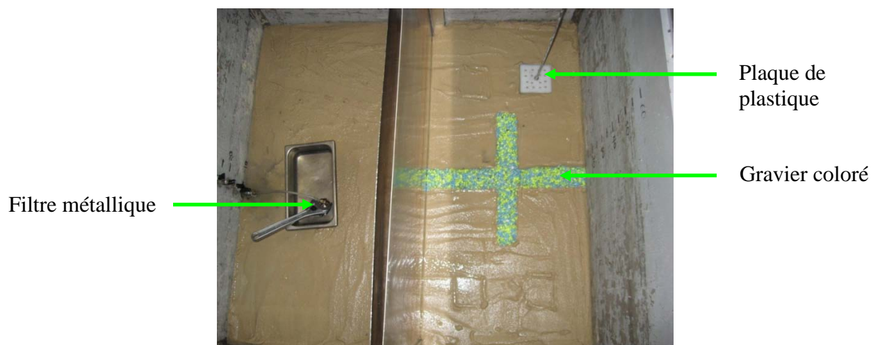
Figure 3.28. Mise en place des instruments sur le tapis de sable grossier (essai 11).
