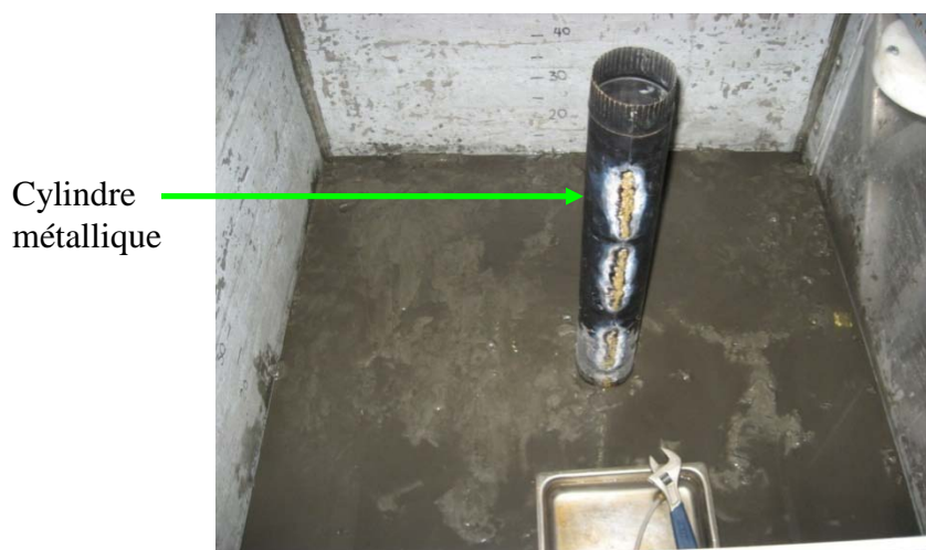
Figure 3.19. Mise en place d'un cylindre de métal au centre de la caisse afin de déposer le sable grossier lors du montage (essai 8).
