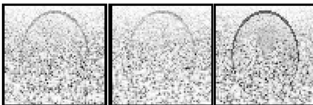
Figure 4.8 : Fantôme Shepp-Logan avec bruit \sigma^2 = 0.3 ; reconstruction avec 64 mesures (gauche), reconstruction sur 64 mesures en sommant les 128 signaux (centre) et reconstruction sur 128 mesures (droite)
