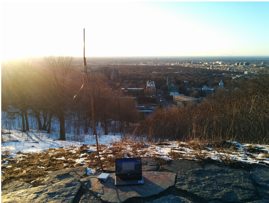
Figure 2.4 Envoi de faux messages ADS-B depuis le mont Royal. L’attaquant utilise une radio logicielle et une antenne afin de forger puis d’émettre des messages ADS-B sur la bande de fréquence de 1090 MHz.
