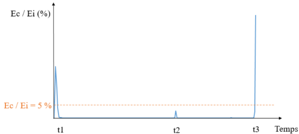
Figure 2-13: Exemple d'évolution du ratio E_c / E_i dans le temps pour une analyse non linéaire par éléments finis sous ABAQUS explicite
