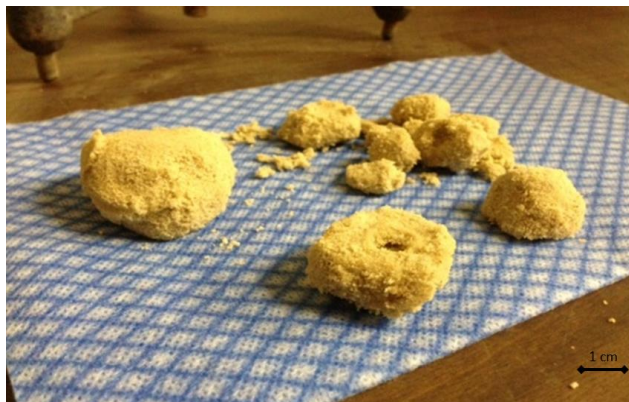
Figure 3.8: Résultats du premier protocole de biocalcification
