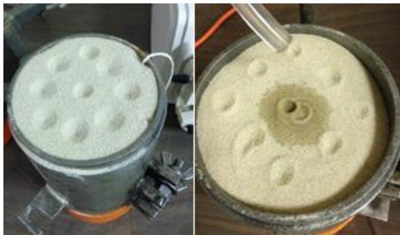
Figure 3.7: Exemple de moule pour le protocole 1, 4 pouces de diamètre et 9 points d'injection.
