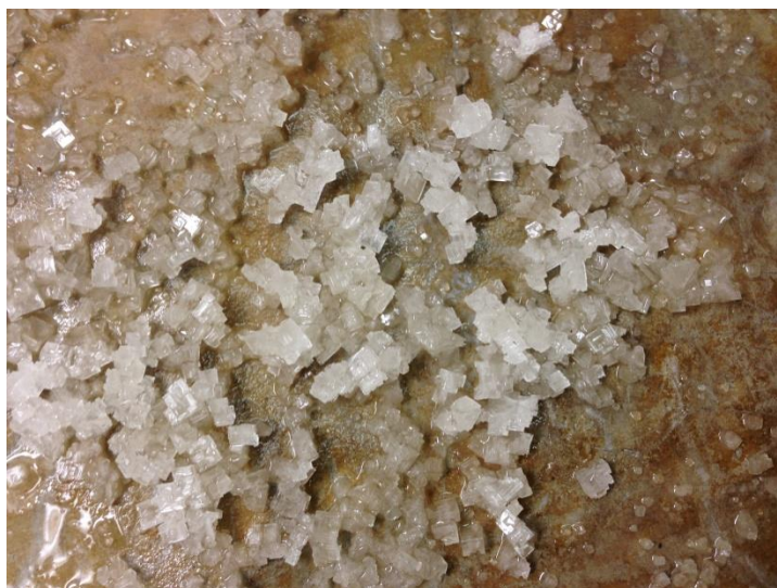
Figure 3.16: Cristal précipité dans le récipient du liquide de sortie de traitement après quelques jours de séchage à l'air libre.
