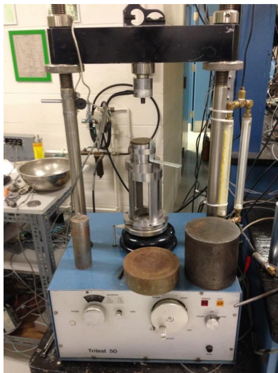
Figure 3.21: Presse utilisée pour la compression simple
