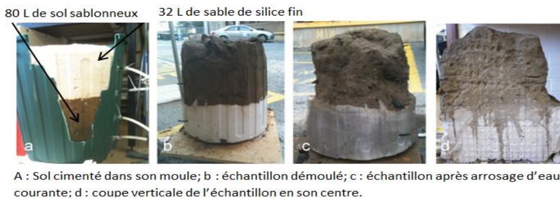
Figure 2.7 Biocalcification d'un échantillon de 112 L, tiré de (Liang Cheng & Cord-Ruwisch, 2014)
