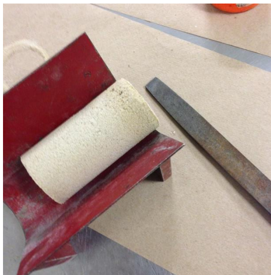
Figure 3.20: Outils utilisés pour le taillage d'un échantillon.
