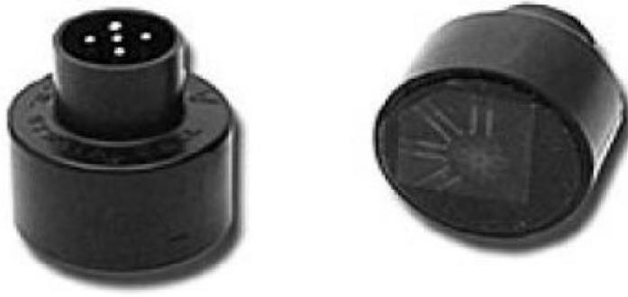
Figure 2.1 : Cellule doorstopper proposée par Leeman en 1969
