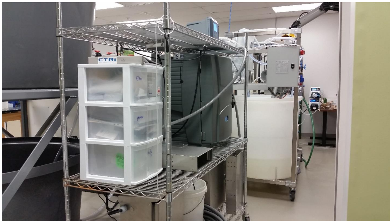
Figure 6.18 : Analyseur de N-NH 3 en continu branché sur l'unité pilote UV
