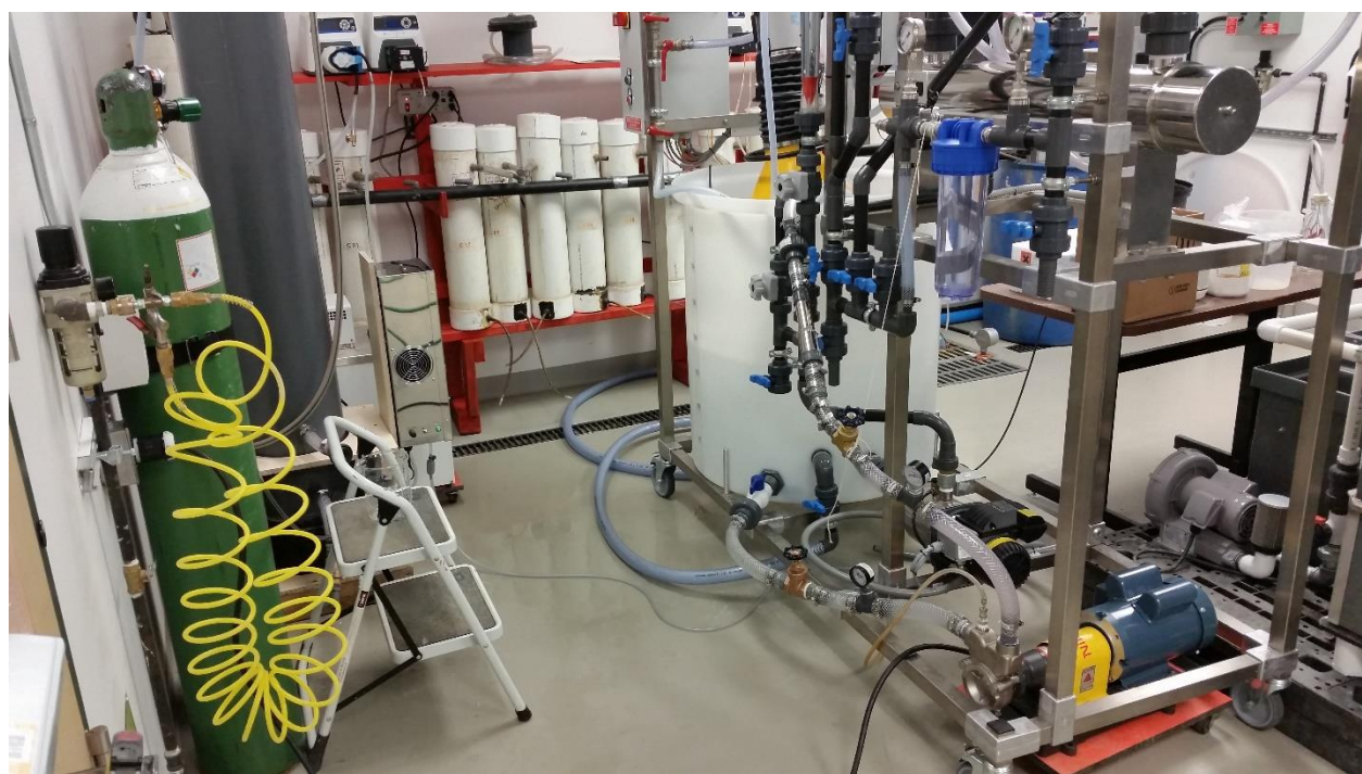
Figure 6.22 : Configuration de la pompe à microbulle avec le mélangeur statique OHR branchés sur l'unité pilote UV
