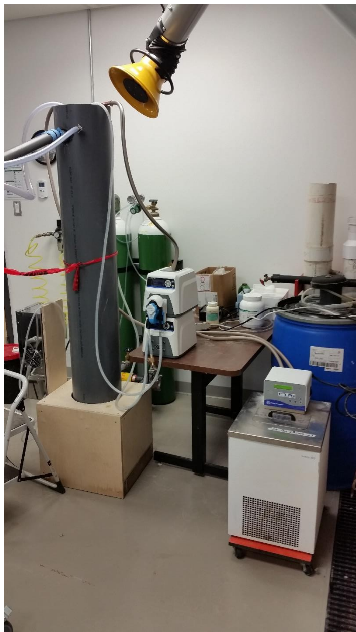
Figure 6.13 : Configuration d'un essai réalisé avec un refroidisseur au glycol et la colonne
