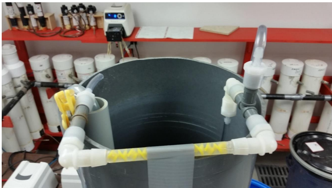
Figure 6.9 : Configuration d'un essai avec mélangeur statique pour injection de \text{H}_2\text{O}_2
