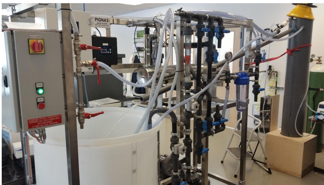
Figure 6.10 : Configuration d'un essai combinant la colonne et l'unité pilote UV pour injection d' \text{O}_3 avec un venturi en passant par un flash reactor
