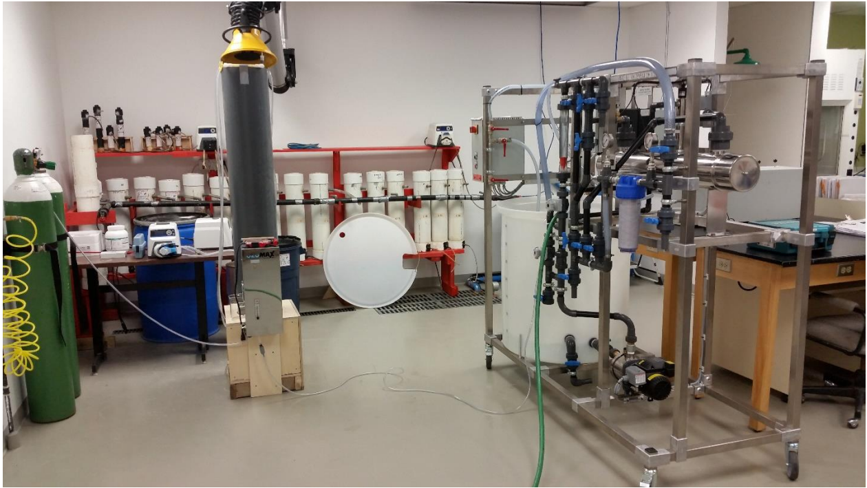
Figure 6.11 : Configuration de l'essai réalisé avec l'unité pilote UV pour former des microbulles avec un venturi ainsi que la pompe centrifuge du pilote
