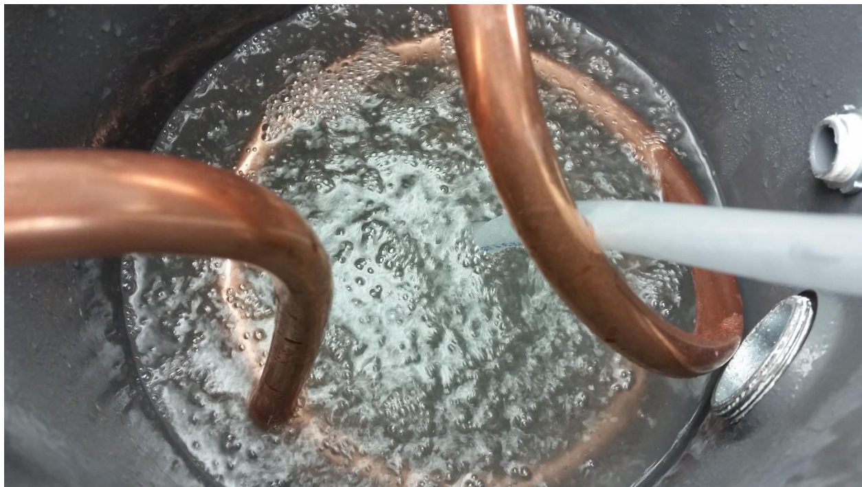
Figure 6.17 : Bulles formées à l'intérieur de la colonne par la pompe à microbulles
