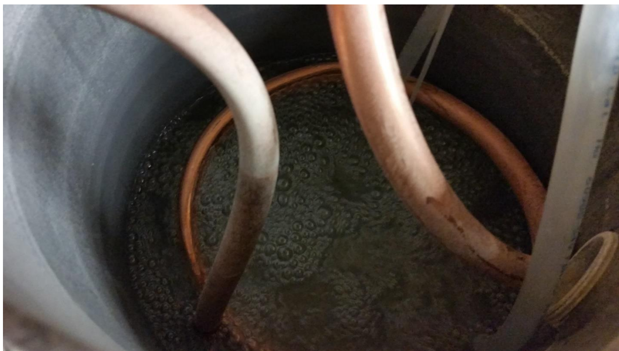
Figure 6.20 : Bulles formées avec la pompe à microbulles et le mélangeur statique OHR
