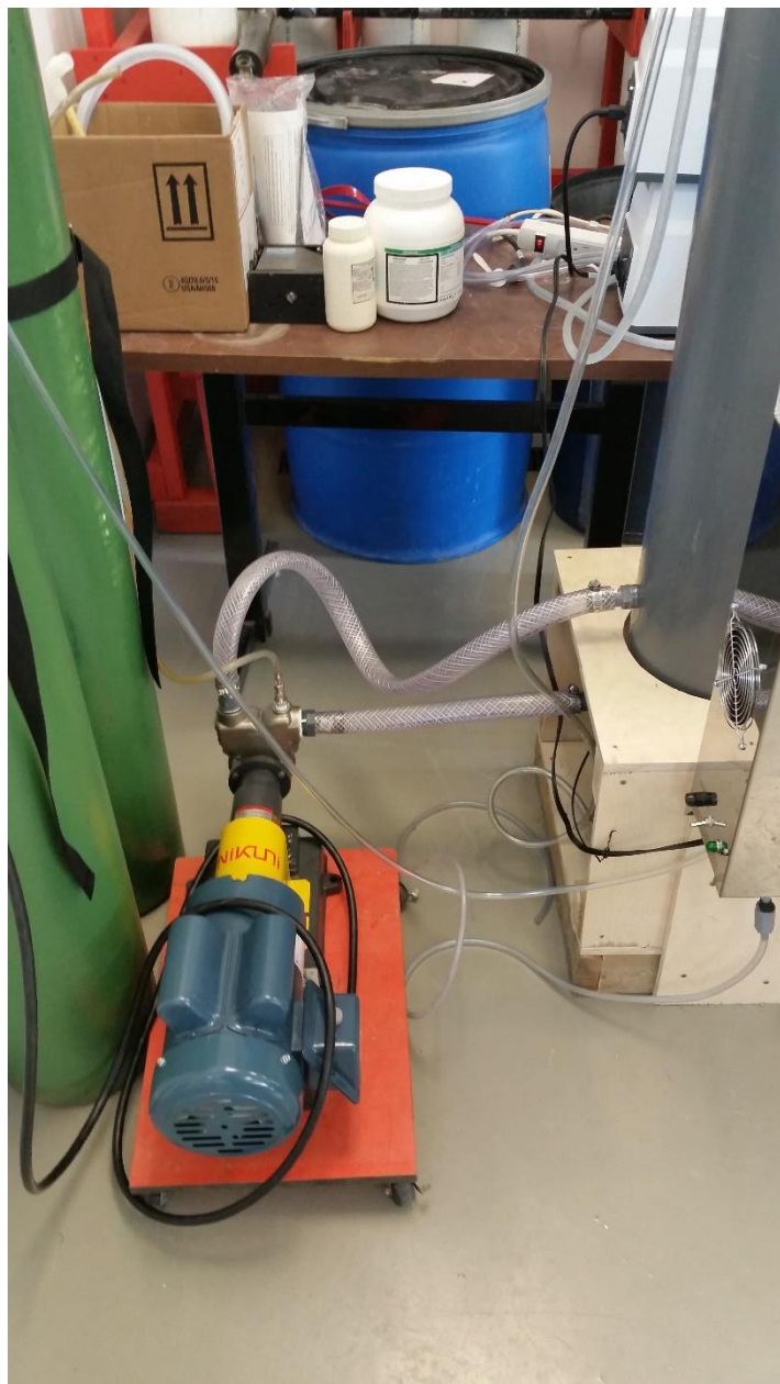
Figure 6.12 : Première configuration de la pompe à microbulles avec la colonne
