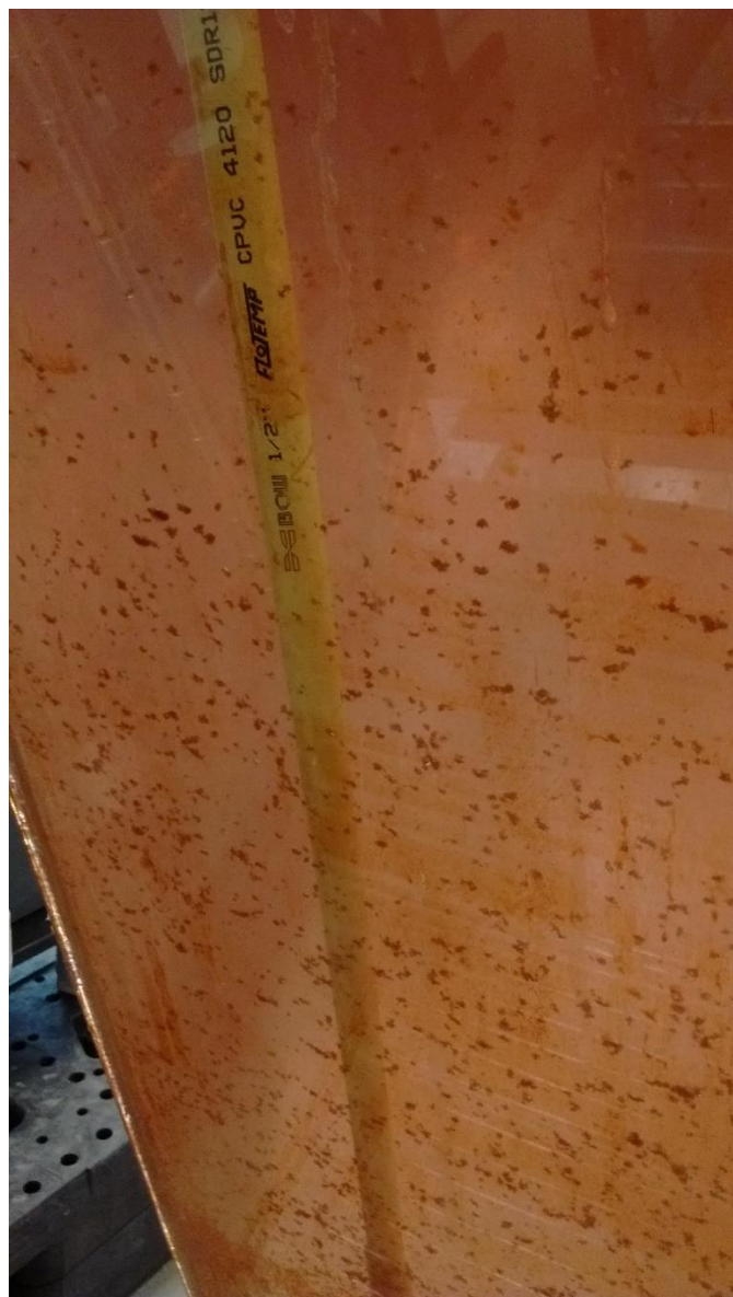
Figure 6.30 : Décantation des floes dans le décanteur
