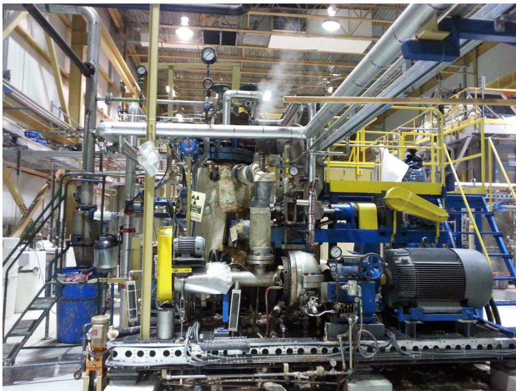
Figure 3.1: The pilot plant disk refining system in the Université du Québec à Trois-Rivières
