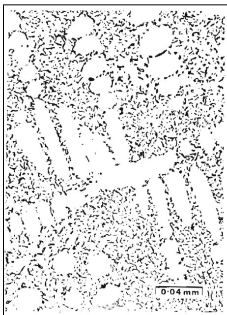
Figure 2.23 : Graphite en corail provenant d'une fonte de haute pureté solidifiée rapidement [56].
