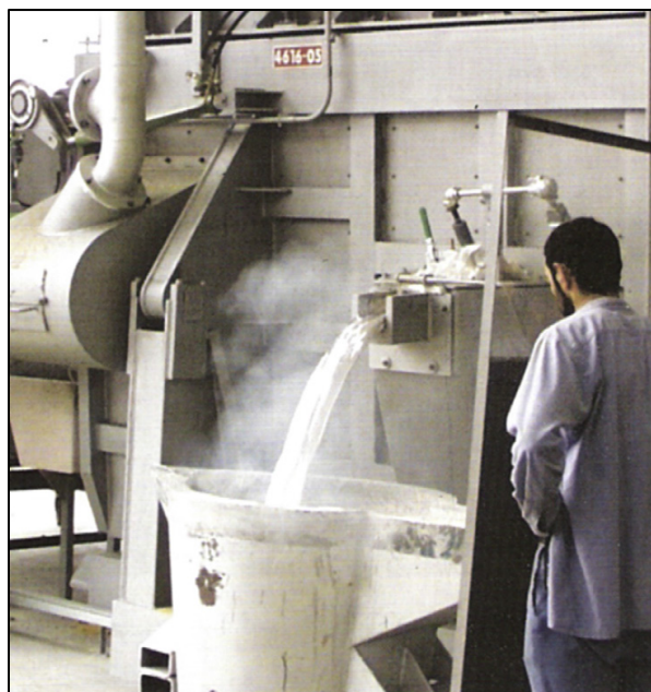
Figure 2.4 : Transfert d'aluminium liquide typiquement rencontré dans certaines fonderies [7].
