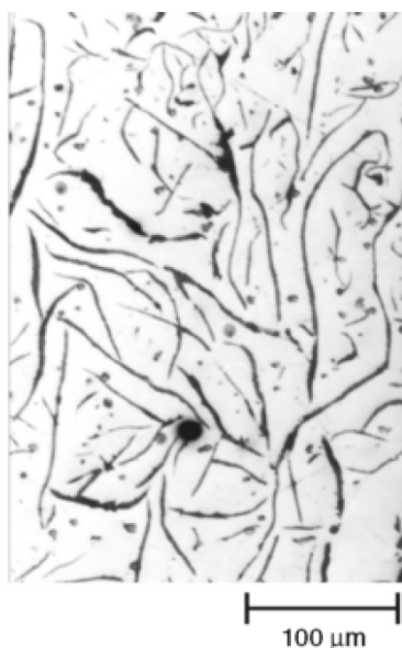
Figure 2.17 : Graphite lamellaire dans une fonte grise [46].
