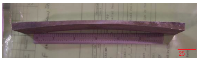
Figure 2.9 Fléchissement d'une plaque produite par SLM causé par le rééquilibrage des contraintes résiduelles lors de l'usinage (Edwards et Ramulu, 2014b)
