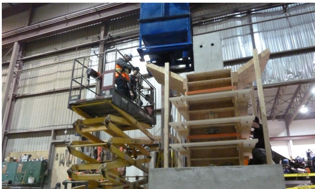
Figure 3.8 : Coulée de la réparation en BFUP de la pile S8
