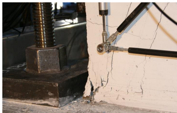
b) Écrasement du béton (coin Sud-Ouest)
