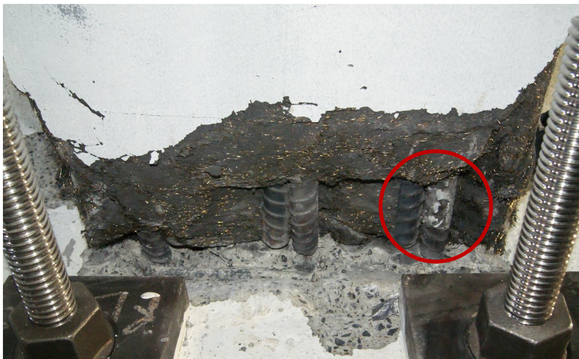
a) Rupture d'une armature longitudinale de la pile S8 (face Ouest, BFUP retiré manuellement)
