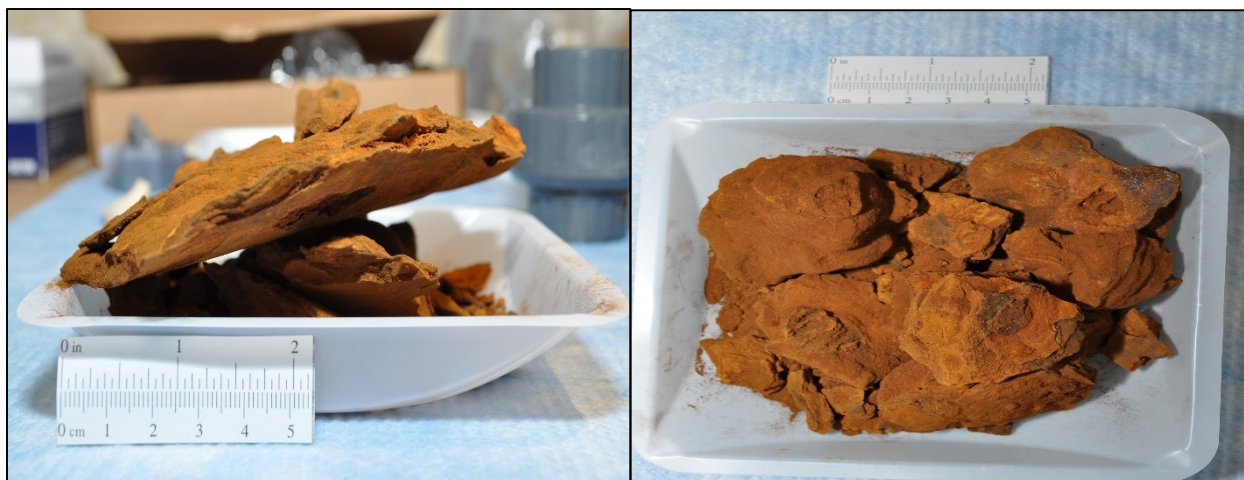
Figure 3.4 : Dépôts de fer recueillis dans les conduites de fontes.
