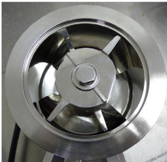
Figure 3.8 Image de l'intérieur d'un Nobilta, (tiré de (Zhou et al., 2011))
