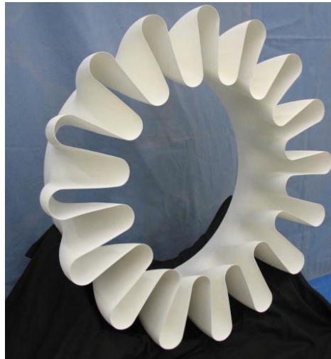
Figure 2.17: Mélangeur d'échappement de CMC d'oxydes développé par la NASA et Rolls Royce [21]
