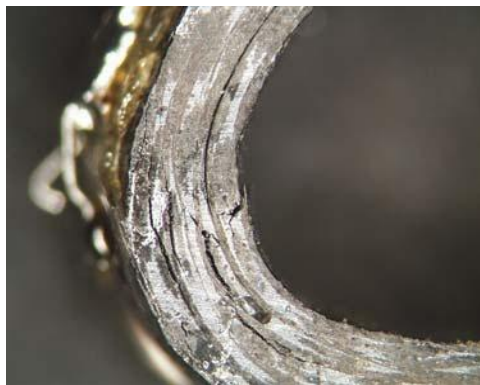
Figure 2.15: Délamination au bord d'attaque d'une aube de stator de turbine suivant un essai de pressurisation à la NASA [109]
