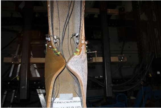
Figure C.5 : Voilement local à la mi-hauteur du spécimen à la fin de l'essai
