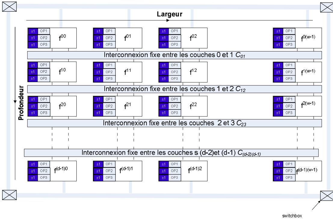
Figure 2. 4 Approche matricielle de connexion des cellules DG_CNTFET
