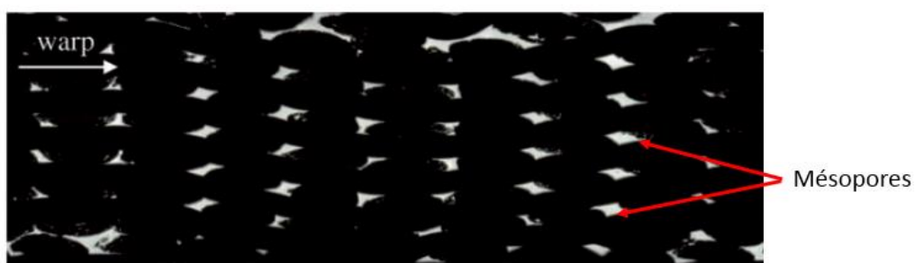
Figure 1.9 : Observation au microscope d'un échantillon de composite renforcé avec un renfort 3D interlock représenté en noir (Vernet & Trochu, 2016)
