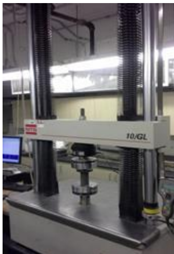
Figure 2-7 : Dispositif expérimental pour des essais en compression uniaxiale
