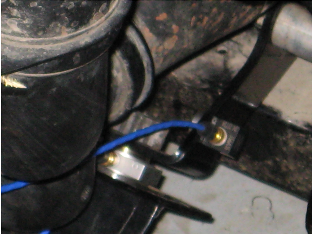
Figure 3.10 – Capteurs posés : on peut voir ici un capteur de force posé à la place normalement occupée par un tampon d’ancrage. Un accéléromètre est placé tout près, dans le même référentiel que le capteur de forces, pour mesurer l’accélération le plus près possible de ce dernier.
