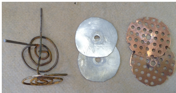
Figure E.2 Différents types d'électrodes de courant testées. De gauche à droite : cuivre en spirale, plaque d'acier inoxydable, plaque de cuivre
