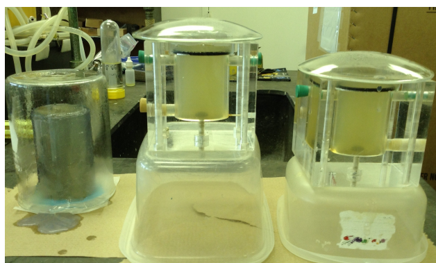
(c) Refroidissement de l'agar en échantillon et dans les deux chambres de la cellule
