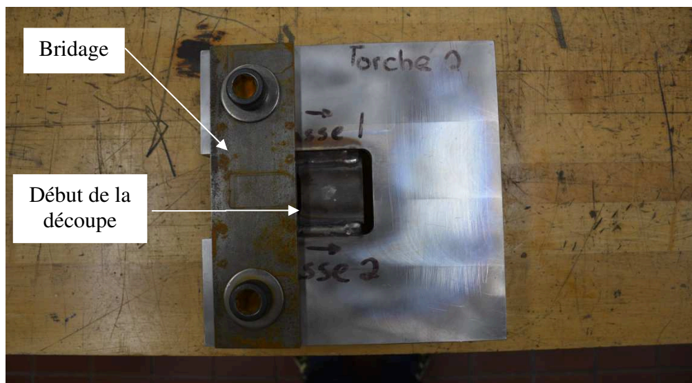
Figure 3-1 Bridage de l'éprouvette CT-RES à l'aide de plaques d'acier positionnées aux trous de chargement
