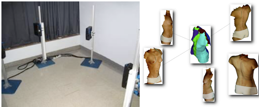
Figure 3.3 : Reconstruction de la surface externe par quatre numériseurs 3D
